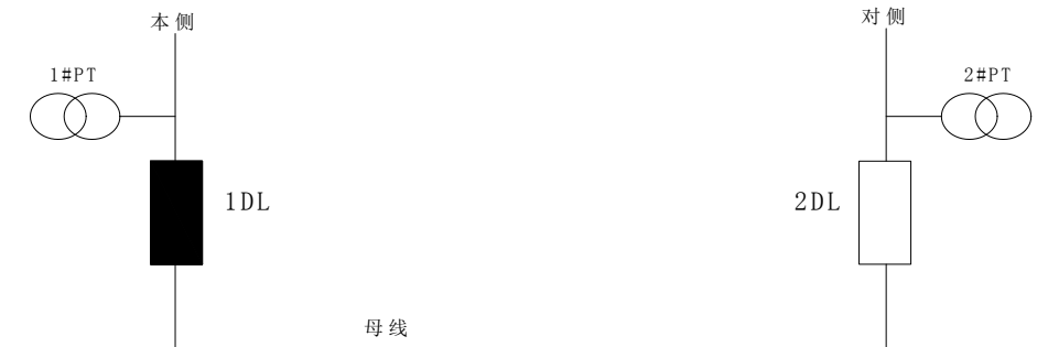
线路备自投模式一次接线示意图
