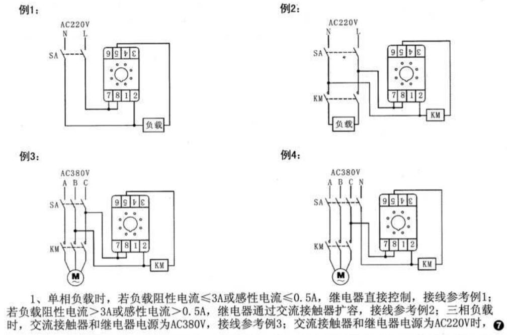
1、单相负载时，若负载阻性电流 $\leq 3A$ 或感性电流 $\leq 0.5A$ ，继电器直接控制，接线参考例1；若负载阻性电流 $>3A$ 或感性电流 $>0.5A$ ，继电器通过交流接触器扩容，接线参考例2；三相负载时，交流接触器和继电器电源为AC380V，接线参考例3；交流接触器和继电器电源为AC220V时，⑦
